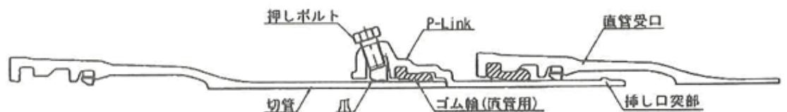
図－5．20 P-Linkを使用したGX形直管の継手構造
