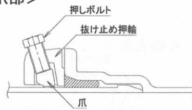
③ 異形管の継手 (切管挿し口との接合)
