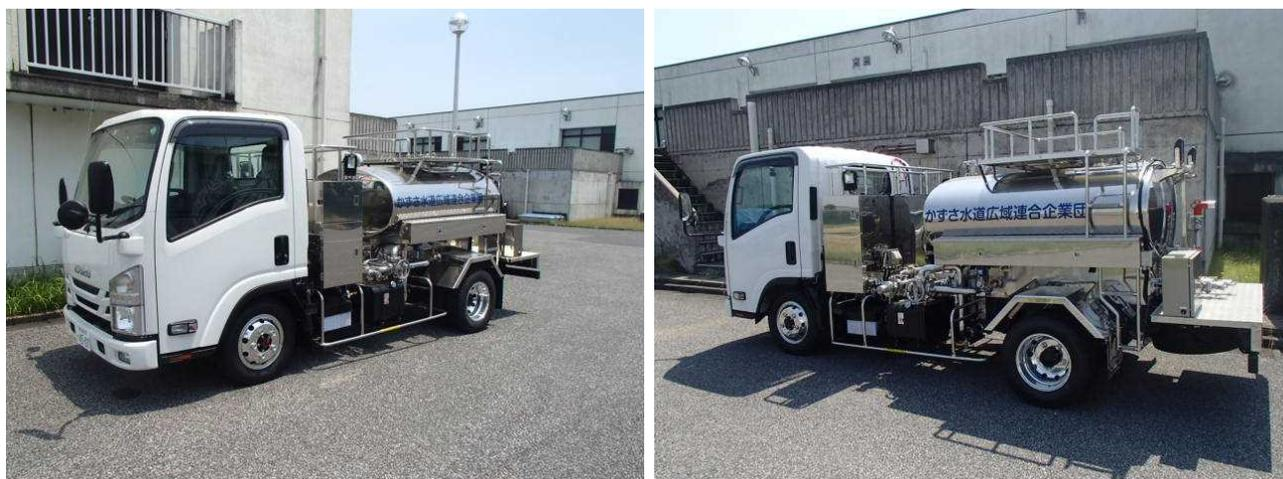
給水車（最大積載量 1.6 t）令和 2 年度更新車両 写真
